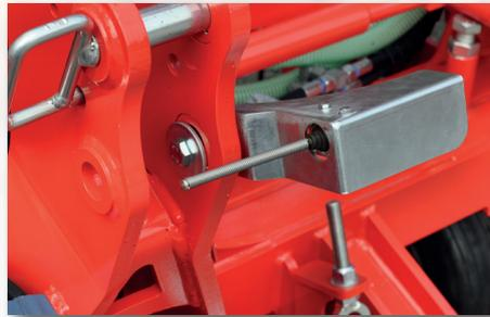
Le capteur sur le dispositif de relevage arrête automatiquement la rotation du rouleau doseur, si la machine est soulevée. Ce capteur n'est pas nécessaire si la machine est équipée d'une prise de signalisation à 7 pins !
