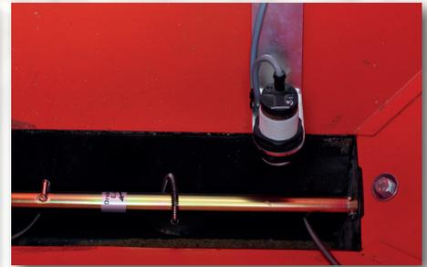
Témoin fin de trémie déclenche une alarme s'il n'y a pas assez de semences dans le réservoir. Le capteur inductif. Capteur intégré est résistant aux chocs.
