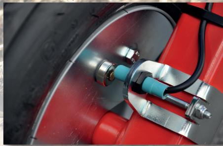
... capteur de roue fixé au cadre mesure la vitesse de déplacement.
