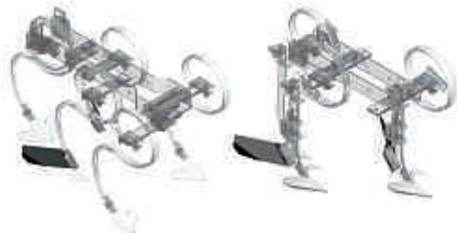
Mit **Häufelscharen** werden die Pflanzenreihen angehäufelt. Sie können sowohl am Stiel der Vibromesserzinke als auch beim S-Zinken mitgeklemmt werden.
