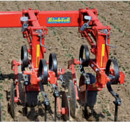
Die **Arbeitstiefe** des Hackeinsatzes ist mit der Spindel des Farmflex-Tastrades stufenlos einstellbar. Mit der Zugfeder und der Verstelleiste kann man den Einzug des Parallelogramms verstellen.
