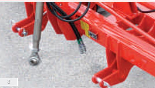
Beidseitig geführte **Unterlenkerbolzen** sorgen für höhere Stabilität.
