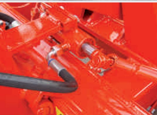
Die **hydraulische Lenkvorsteuerung** verstärkt den mit dem Oberlenker erzielten Lenkeinschlag nochmals. Am Vorgehende muss die Kolbenstange immer in die andere Richtung geschaltet werden. Empfohlen bei Hanglagen über 6 %.
