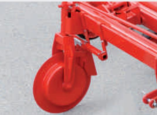
**Spurkranzräder** für eine optimale Führung des Hackgerätes. Die Traktorvorderräder werden nicht entlastet.
