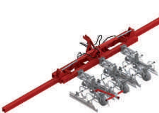
Frontrahmen hydraulisch klappbar
