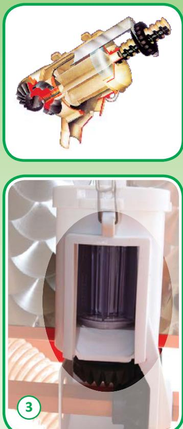
① Il **distributore volumetrico MINIMAX** è facilmente regolabile e consente la distribuzione di fertilizzante a diversi dosaggi mantenendo elevata la precisione distributiva: 50-700 kg/ha
