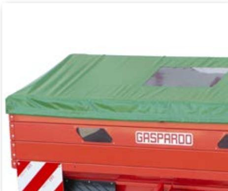
**Bâche repliable avec fenêtre d'inspection**
