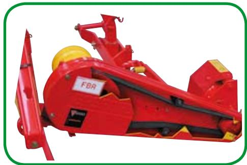
La falciatrice è azionata mediante il collegamento di un cardano con la P.d.p. della trattore che, per mezzo di una trasmissione a puleggia e cinghie contenuta in un apposito carter di protezione, trasmette il moto a due distinti sistemi biella-manovella destinati all'azionamento della lama e dei denti lama.
