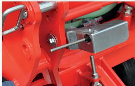
Ein **Hubwerksensor** schaltet die Säwalze bei angehobenem Gerät automatisch ab. Bei 7-poligem Signalkabel nicht erforderlich!
