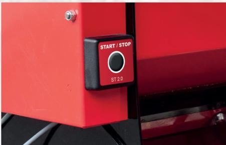
Der **Abdrehtaster** hinten am Gerät ermöglicht das Durchführen der Abdrehprobe direkt am Gerät.
