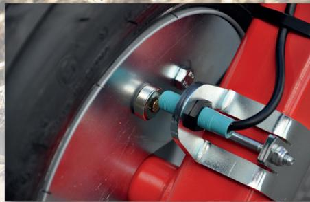
... oder ein **Radsensor** misst die Geschwindigkeit an einem Rad des Anbaugerätes.
