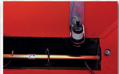
Der **Füllstandssensor** meldet, wenn sich das Saatgut dem Ende zuneigt. Der Sensor arbeitet induktiv und ist dadurch erschütterungsunabhängig.
