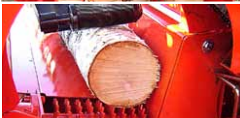
Holzstammzufuhr mit Metalldornwalze.
