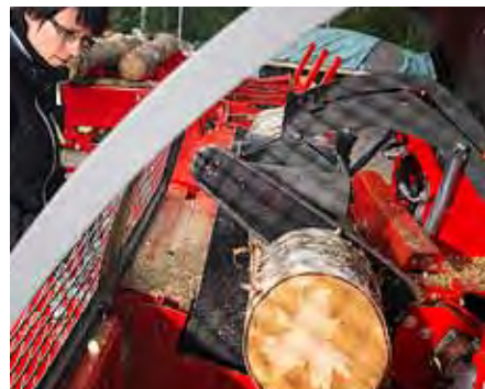
Das Holz wird mit einer hydraulischen 20" 508 mm langen Kettensäge geschnitten.
