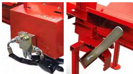
Ein Geschwindigkeitsregelventil ist als Zubehör erhältlich.
