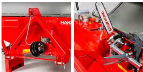
Zapfwellenmodell mit Dreipunkt-Hubwerk.
