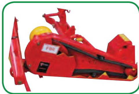
Das Mähwerk wird über die Verbindung einer Gelenkwellen an die Zapfwelle des Traktors angetrieben, welche den Kraftfluss über einen Riementrieb mit Riemenscheibe, der sich in einer Verkleidung befindet, an die beiden getrennten Systeme Pleuel-Kurbeltrieb überträgt, welche zum Antrieb des Messers und der Finger bestimmt sind.
