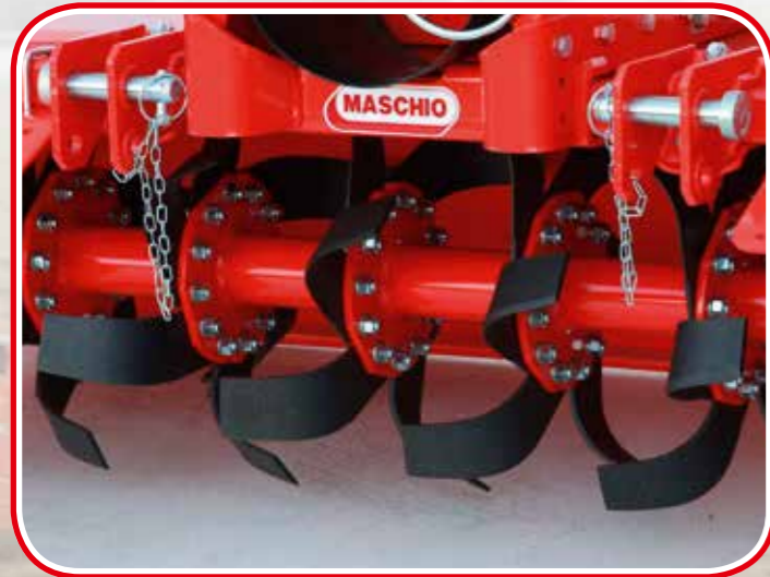
W - A - E 6 zappette per flangia 6 blades per flange 6 lames par flasque
