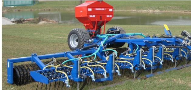
Durch Anbau eines hydraulischen Striegels (12mm Zinken) eignet sich MaxiRoll zur kostengünstigen Stoppelbearbeitung und Saatbettbereitung. Der zusätzliche Anbau von Crackerboard, Maulwurfplanke und Sätechnik ermöglicht die komplette Grünlandpflege in einer Überfahrt sowie die Aussaat von Zwischenfrüchten.
