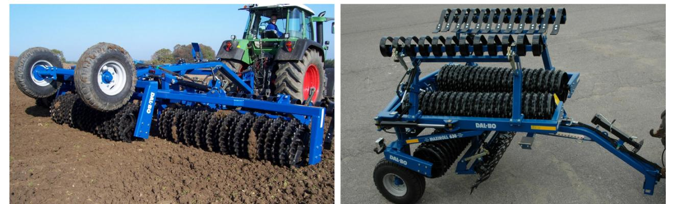
Schwere vollhydraulische Ackerwalze. Vorbereitet für Crackerboard **DAL-BO**
