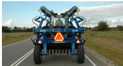
MaxiRoll hat nur 2,50m Transportbreite, die 8,3m Heavy Duty und die fünfteiligen Varianten 3,00m. Beleuchtungsanlage und Warndreieck sind serienmäßig
