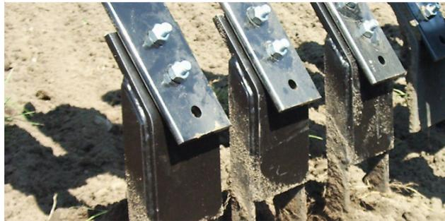
Für besonders schwere Böden bzw. bei Verschlammungen empfehlen wir die speziell entwickelten Krustenbrecherzinken.
