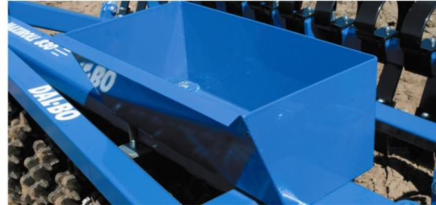
Auf den Rahmen der Seitensektionen können Steinkästen montiert werden, die beim Klappen automatisch entleert werden.
