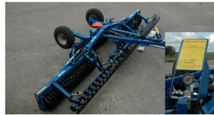
Nachdem die Walze ganz ausgeklappt ist, wird sie abgesenkt und das Fahrgestell vom Boden angehoben. Jetzt nur noch schnell die Seitenteile hydraulisch vorspannen (33% Gewicht auf jede Sektion).
