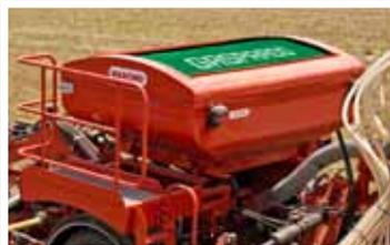
La trémie d'une capacité de 2550 litres est située au-dessus des roues pour une meilleure répartition du poids. Des pesons permettent une vérification du poids de la semence ou de l'engrais contenu dans la trémie. L'ouverture électrique EASY TOP, ainsi que l'échelle télescopique, assurent un chargement facile.
