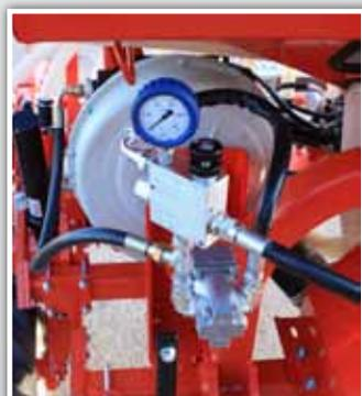
La soufflerie peut être entraînée par la prise de force (en standard) ou travailler indépendamment grâce à un moteur hydraulique facilement réglable depuis la cabine.
