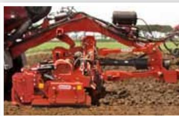
Un châssis robuste relie le tracteur et la herse à la trémie. Ceci rend l'appareil facilement maniable. La connexion au tracteur est assurée par un anneau de remorquage de 50 mm de diamètre.
