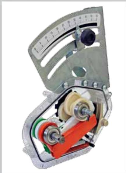
La boîte de vitesse 3 cames permet un entraînement uniforme et constant. Grâce aux roulements à billes, les cardans seront moins sujets à l'usure. Le boîtier a une lubrification à bain d'huile, avec fenêtre d'inspection; son calibrage est rapide et précis.
